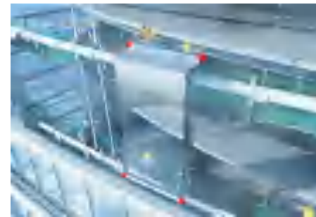
单元板块安装
