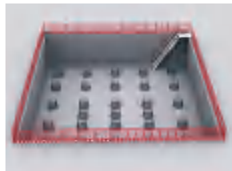
基坑临边防护
