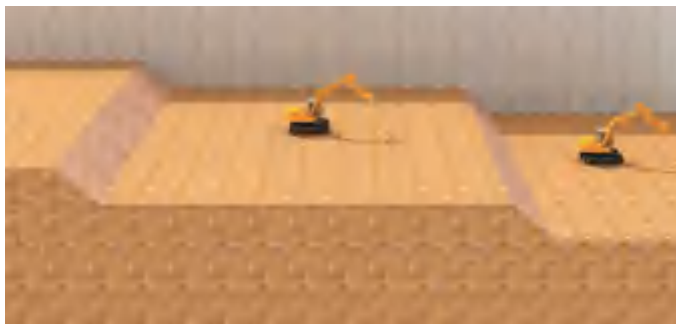
按顺序分层开挖作业
